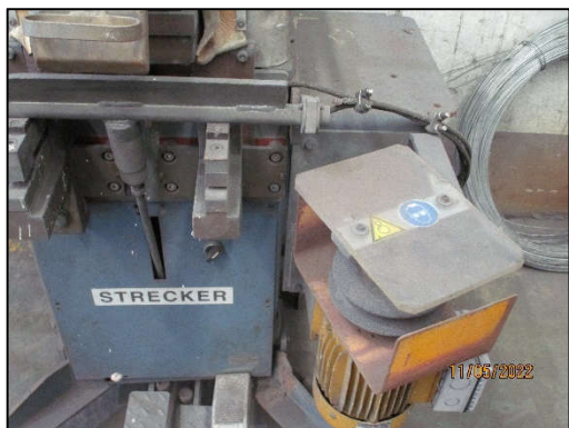
รูปที่ 3-38 การ์ดป้องกันวัสดุกระเด็นเข้าตาที่เครื่องจักร
