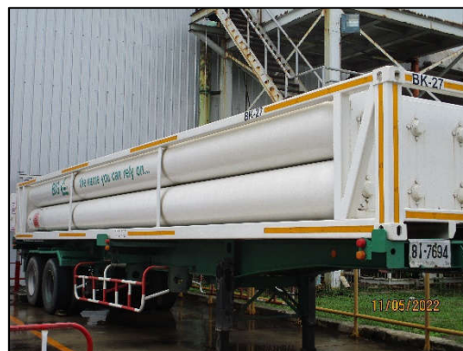
รูปที่ 3-47 การเก็บก๊าซไฮโดรเจนที่มีอากาศถ่ายเท
